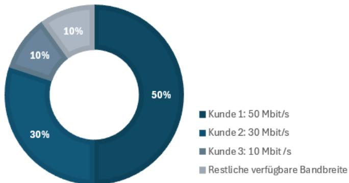
Sollte der Netzwerksektor ausgelastet sein, so wird die Netzwerkkapazität nach dem Verhältnis der jeweiligen Tarife aufgeteilt, jeweils gedeckelt mit der maximalen Tarifbandbreite.
