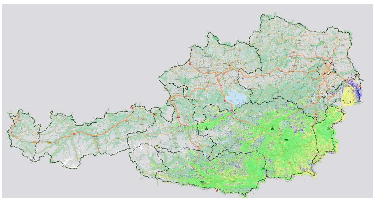
Mit Inbetriebnahme der dargestellten Anlagen im 2. Quartal 2024 wird ein Versorgungsgrad innerhalb der definierten Region von 85 % für mobilen und 54 % für portablen Indoor-Empfang erreicht.
