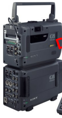
Portabler HDCAM SR Recorder HD 1080i/25 oder 1080p/25 4:2:2 oder 4:4:4, 4 - 12 Audiospuren mit 24 Bit, Sony, 2006
